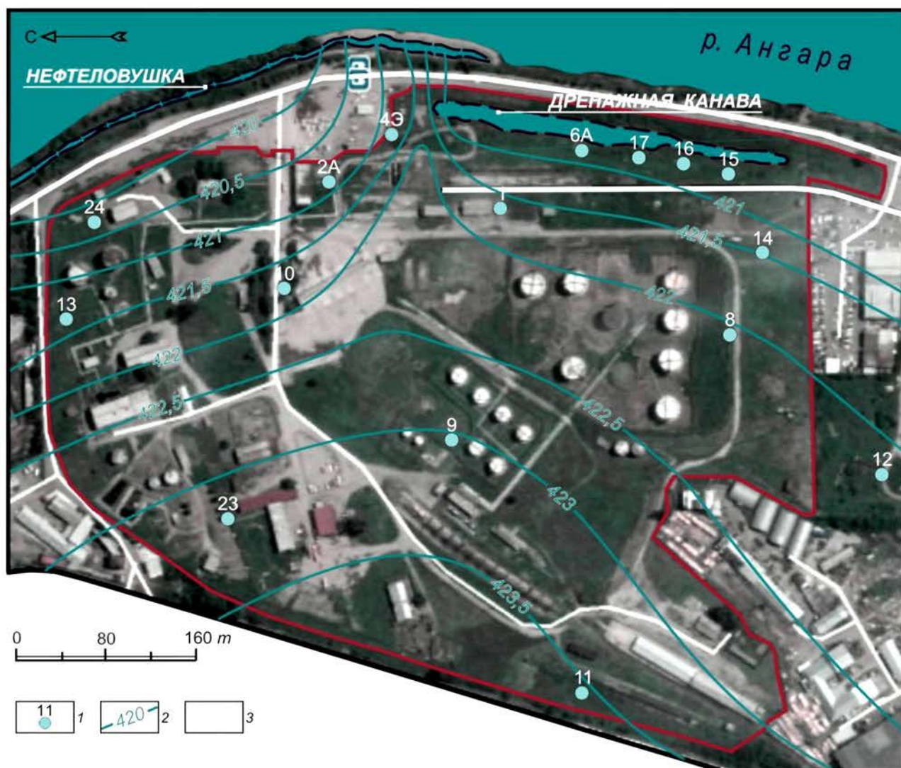
Рис. 4-14. Схематическая карта гидроизогипс грунтового потока Жилкинской нефтебазы [данные ЦГЭИ ИрГТУ (2006 г.), ИТЦГМГС (2011 г.) с изм.] 1 – скважина; 2 – гидроизогипс в абс. отм., м; 3 – граница территории базы
