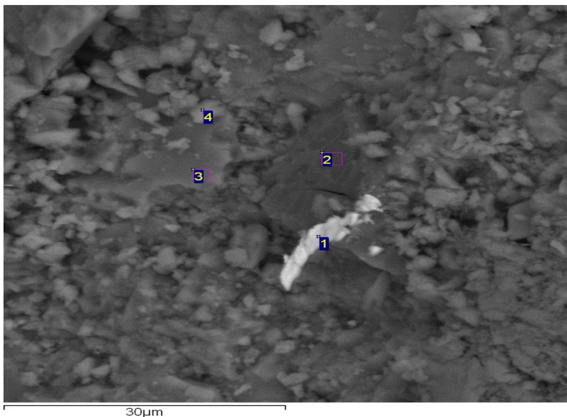
Рис. 5.14 – Электронно-микроскопический снимок новообразований на поверхности известняка
