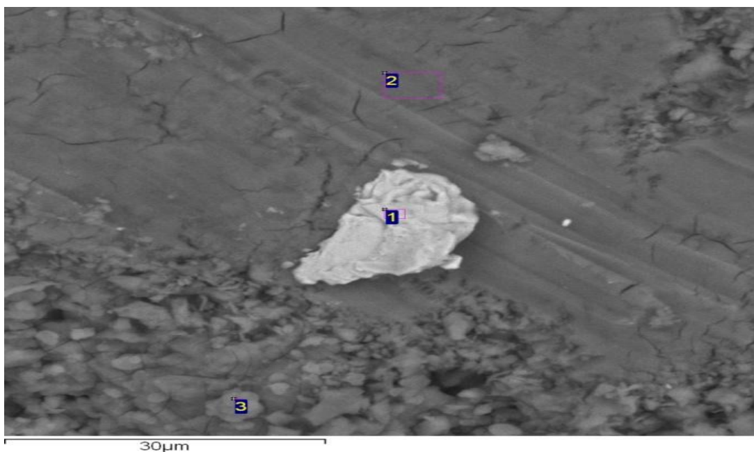
Рис.5.13 – Гидрокислы железа на поверхности кальцита
