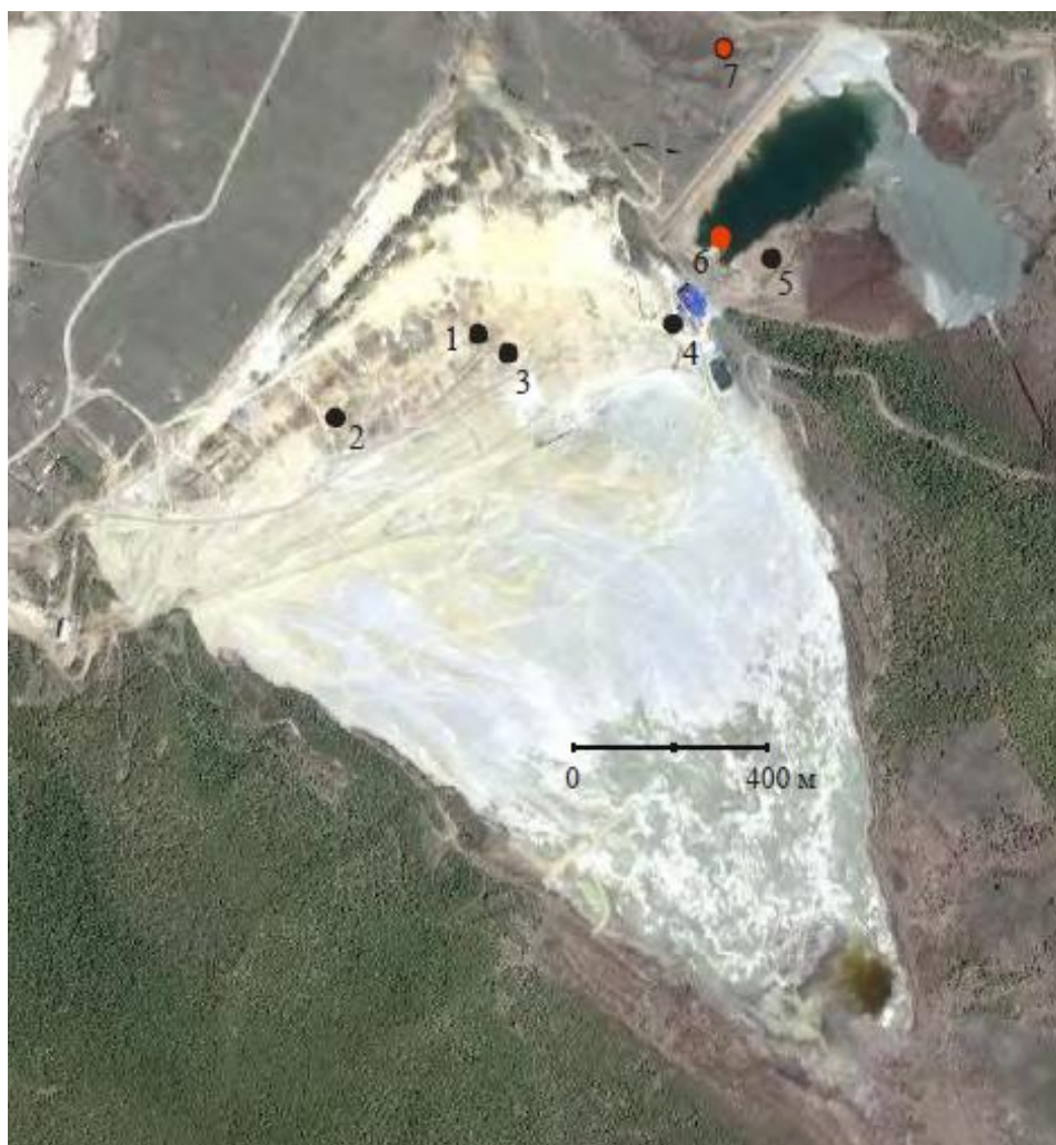
Рис. 3.1. Космоснимок намывного хвостохранилища пади Барун-Нарын с точками отбора проб песков и воды, использовавшихся в лабораторных экспериментах: 1, 2 – пески из нижних горизонтов, 3 – пески с поверхности массива, 4 – пески возле загрузочного бункера обогатительной фабрики, 5 – пески с поверхности хвостохранилища после вторичной переработки на обогатительной фабрике, 6 – вода из пруда накопителя, используемая в
