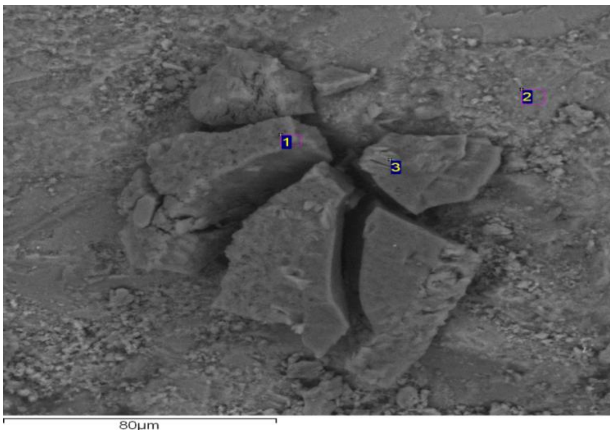
Рис. 5.4 – Электронно-микроскопический снимок новообразований: 1,3 – серосодержащие соединения кальция с примесью цинка, кадмия; 2 – фторид кальция
