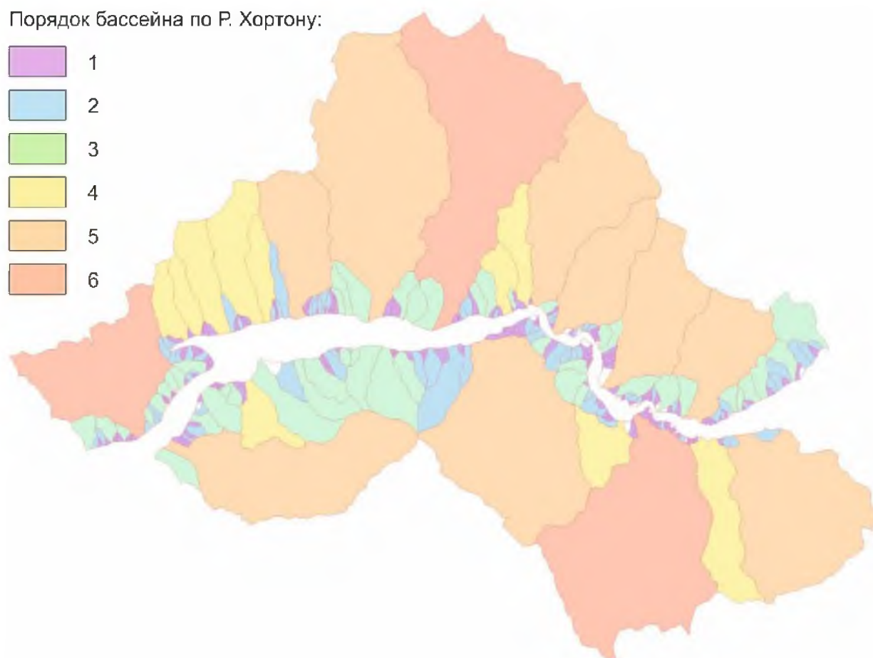
Рисунок 5.14. Карта-схема водосборных бассейнов Улан-Баторской агломерации.
