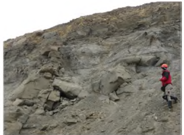
Рисунок 4.9. Вертикальная трещина на поверхности откоса ( А ); хорошо выраженная зона трещиноватости горных пород в откосе ( Б ) +220-й горизонт.
