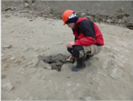
Рисунок 4.8. Просадка ( А ); трещины вдоль борта карьера ( Б ); провал ( В ); зона просадок вкрест простирания уступа +220-ого горизонта ( Г ).
