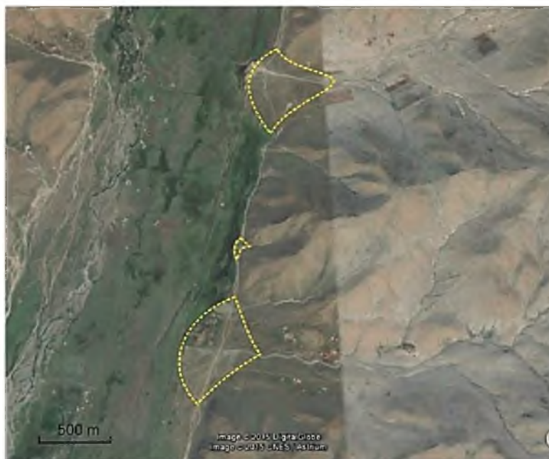
Рисунок 5.12. Выраженные в рельефе конусы выноса водосборных бассейнов.
