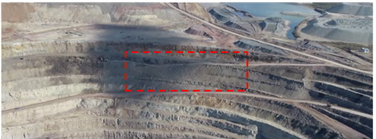
Рисунок 4.12. Единый шлейф осыпей в юго-восточной части карьера (фото 2018 г.).
