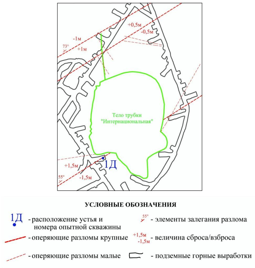
Рис. 7.1 Расположение опытной скважины №1Д на горизонте -790 м относительно тела трубки «Интернациональная» и выделенных в процессе работ оперяющих разломов (составлена по материалам МСШСТ и Мирнинской ГРЭ)
