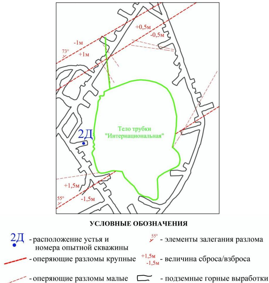
Рис. 7.3 Расположение опытной скважины №2Д на горизонте -790 м относительно тела трубки «Интернациональная» и выделенных в процессе работ оперяющих разломов (составлена по материалам МСШСТ и Мирнинской ГРЭ)
