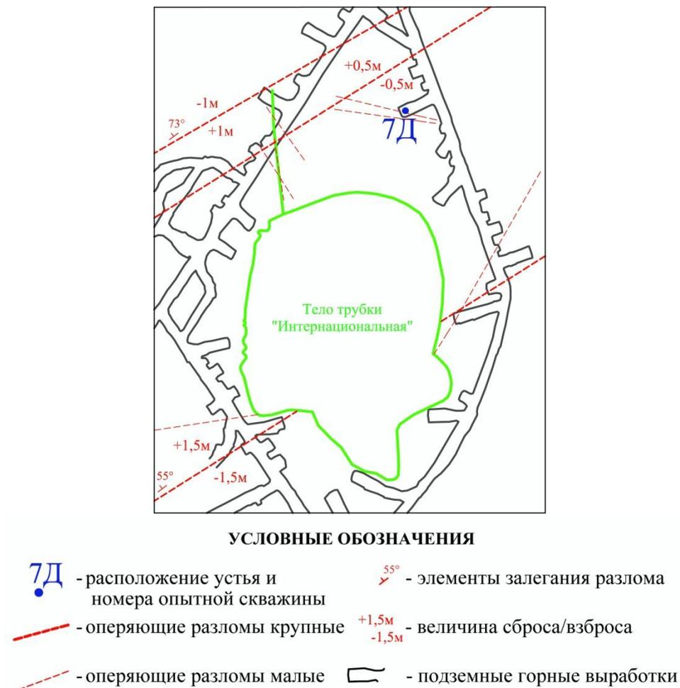
Рис. 7.11 Расположение опытной скважины №7Д на горизонте -790 м относительно тела трубки «Интернациональная» и выделенных в процессе работ оперяющих разломов (составлена по материалам МСШСТ и Мирнинской ГРЭ)
