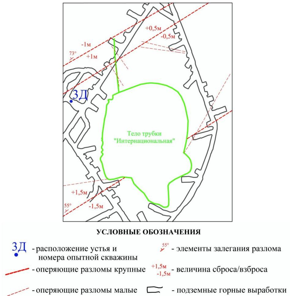
Рис. 7.5 Расположение опытной скважины №3Д на горизонте -790 м относительно тела трубки «Интернациональная» и выделенных в процессе работ оперяющих разломов (составлена по материалам МСШСТ и Мирнинской ГРЭ)
