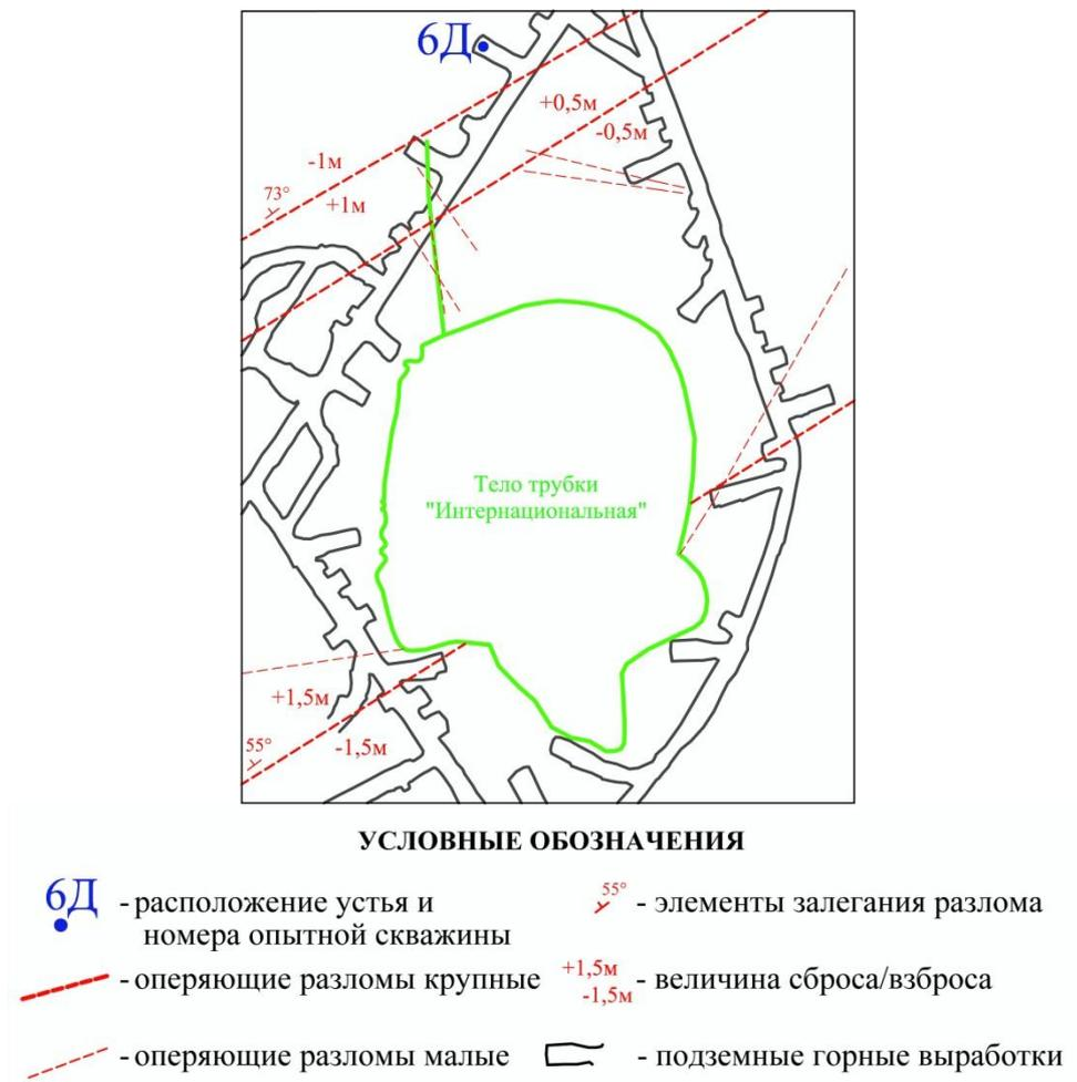
Рис. 7.9 Расположение опытной скважины №6Д' на горизонте -790 м относительно тела трубки «Интернациональная» и выделенных в процессе работ оперяющих разломов (составлена по материалам МСШСТ и Мирнинской ГРЭ)
