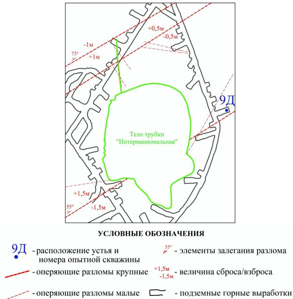
Рис. 7.13 Расположение опытной скважины №9Д на горизонте -790 м относительно тела трубки «Интернациональная» и выделенных в процессе работ оперяющих разломов (составлена по материалам МСШСТ и Мирнинской ГРЭ)
