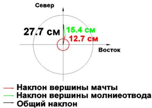
Рис. 4.12. Направление отклонения мачты и молниеотвода
