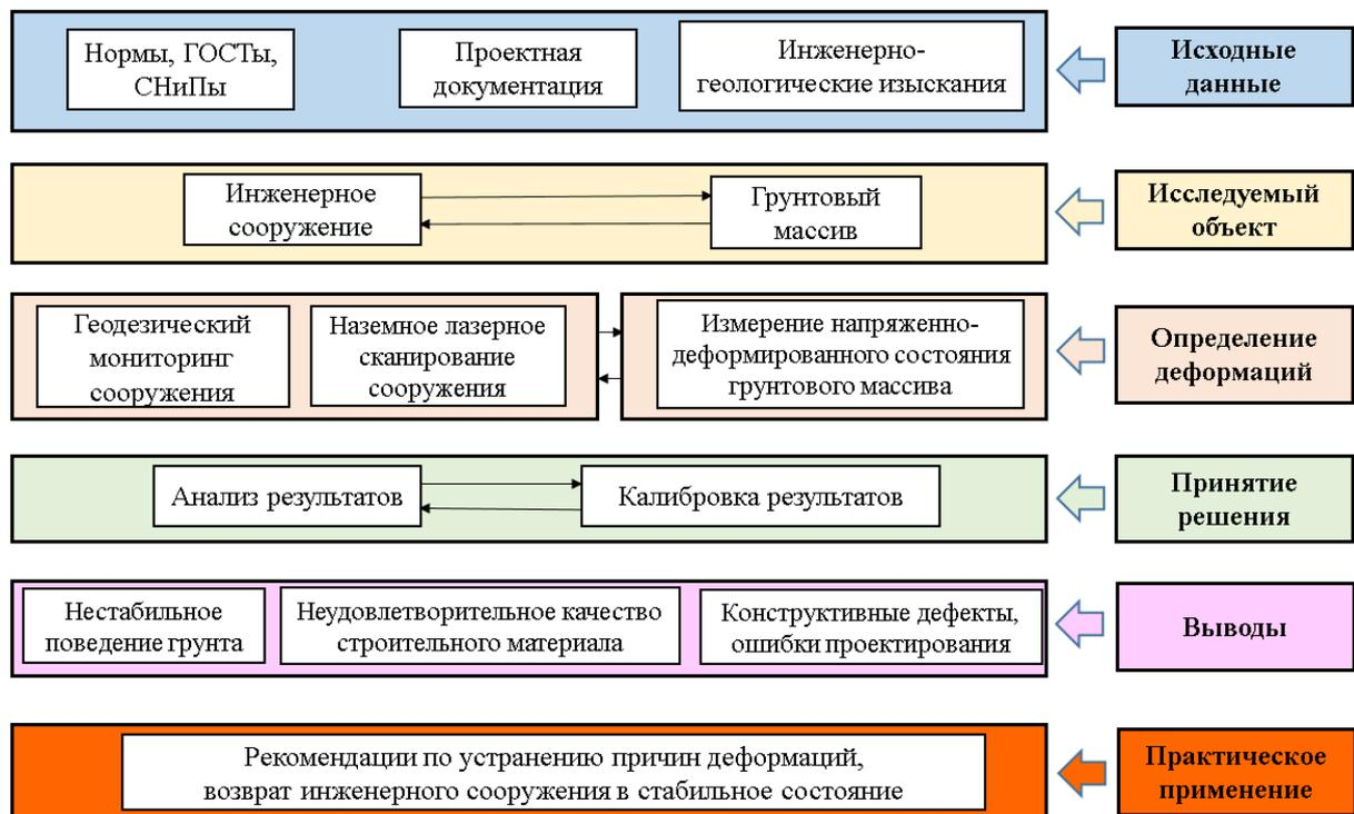
Рис. 6.1. Общая схема комплексного подхода определения деформаций методом конечных элементов и наземным лазерным сканированием
