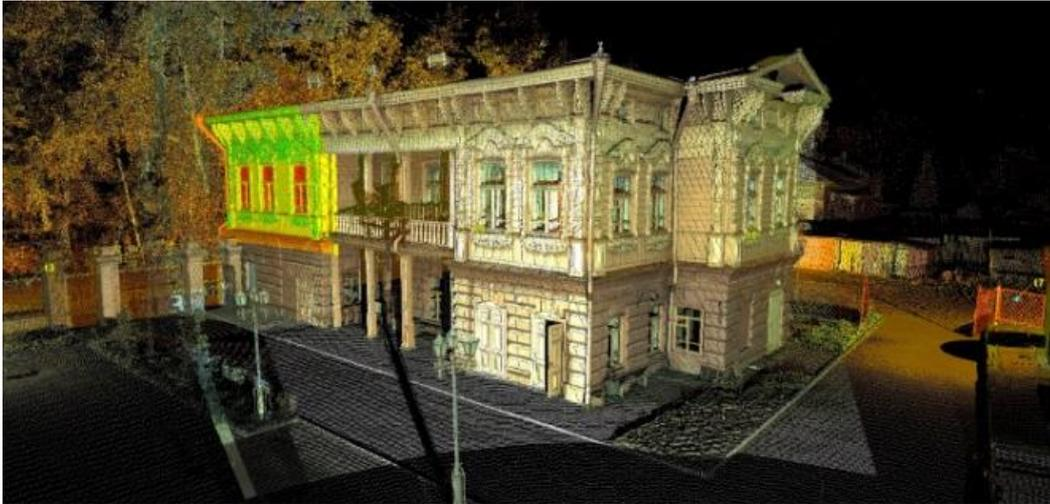
*Рис. 2.6. Облако точек с наложением фото при наземном лазерном сканировании*
