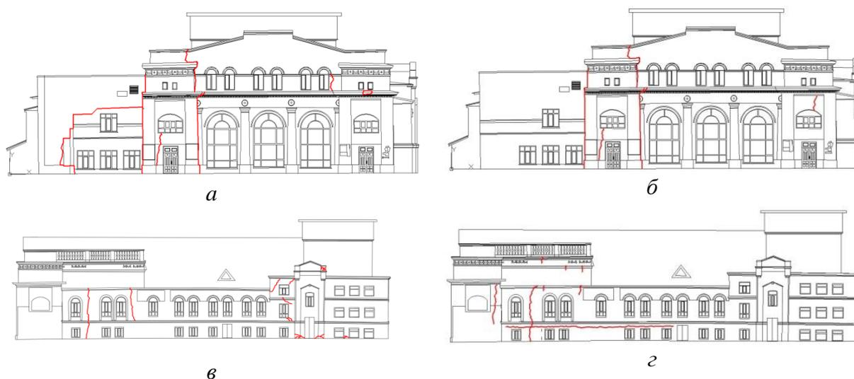
Рис. 4.8. Трещины фасадов: главного в году: а) 2012, б) 2017 и северного: в) 2012; г) 2017.
