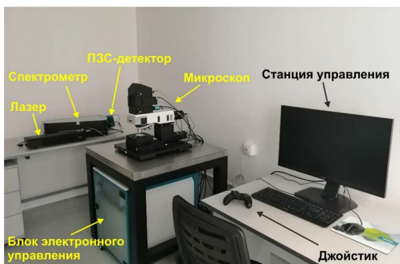
Система для конфокальной Рамановской спектроскопии WITec alpha 300R в лаборатории орогенеза ИЗК СО РАН.
