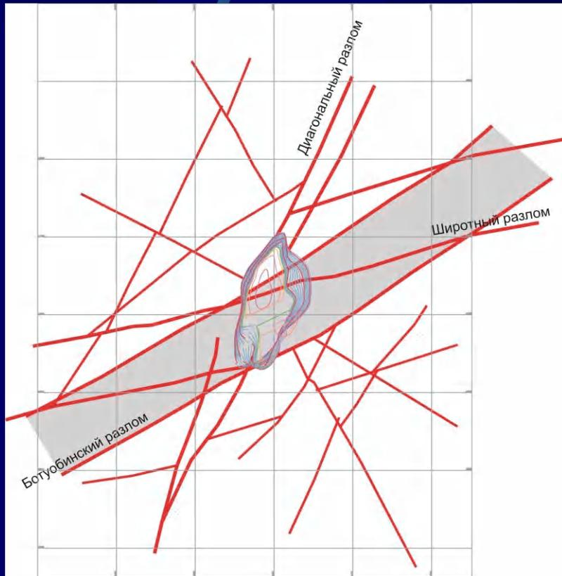
Схемы разломно-блокового строения месторождения трубка "Нюрбинская"
