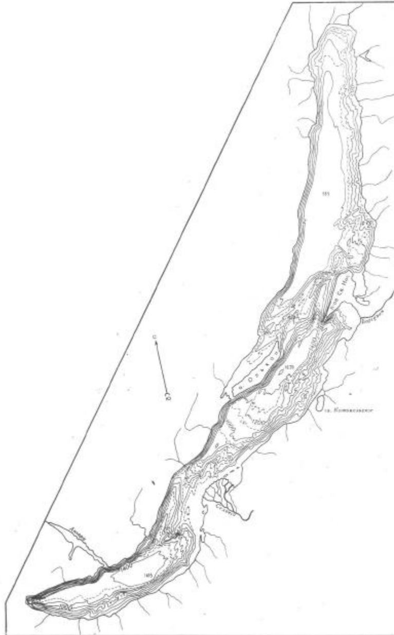
Рис. 2. Схема подводного рельефа впадины оз. Байкал, составленная В. И. Галкиным (Логачев, 1974). Основные изобаты проведены через 200 м, дополнительные (пунктир) — через 100 м.
